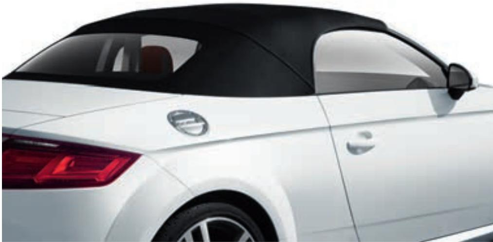
Qualität erhöht, Außengeräusche reduziert: Das vollautomatische Akustikverdeck aus isoliertem, dreilagigem Stoffgewebe besticht durch hochwertige Bezüge in drei verschiedenen Farbtönen. Es lässt sich bis zu einer Geschwindigkeit von 50 km/h in 10 Sekunden öffnen und schließen und sorgt für eine angenehm leise Fahrt sowie exzellente Wärmedämmung.
